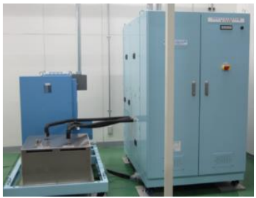
10kW中規模 スタック評価設備
