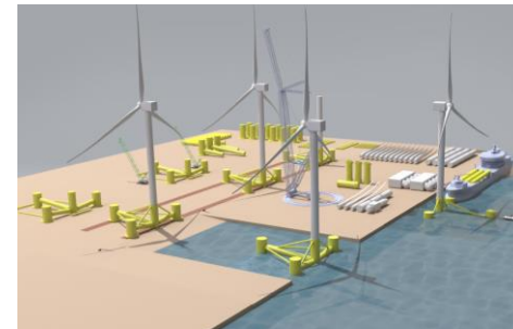
【出典】WindpowerMONTHLY HPより 組立、進水、保管工程の例イメージ
