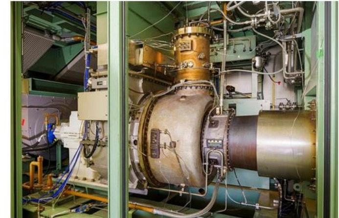
本研究開発に用いたIHI製2,000kW級ガスタービン「IM270」
