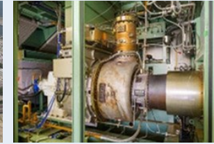
IHI製2MW級ガスタービン
