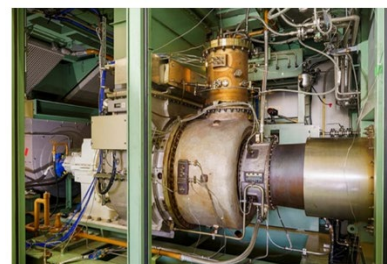
IHI製アンモニア専焼2,000kW級 ガスタービン「IM270」
