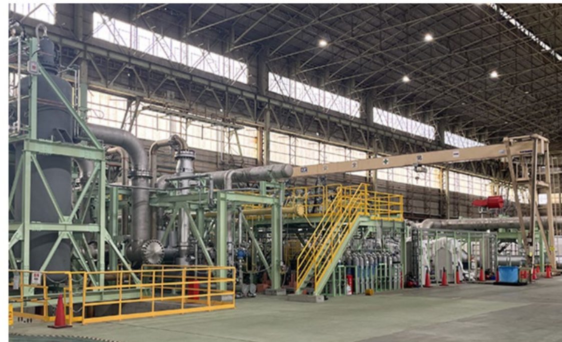
IHI相生工場に新設した大型燃焼試験設備
