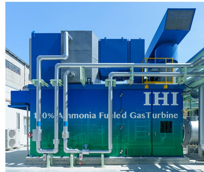
相生事業所で長期耐久試験中のIHI製2,000kW級ガスタービン「IM270」
