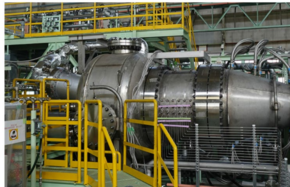
GEベルノバのFクラスガスタービンの燃焼器を使用し100%アンモニア燃焼試験に成功した試験設備
