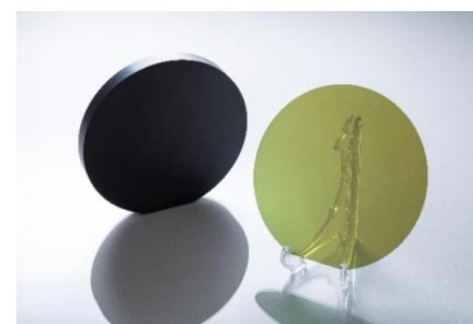
(左から)SiCインゴット、SiC単結晶基板
