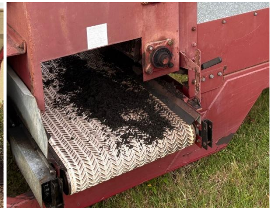
▶既存のスピナータイプのマニユアスプレッダーでバイオ炭を散布
