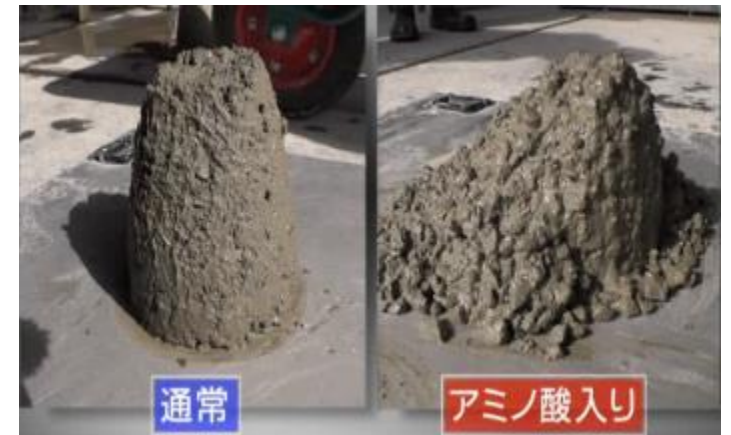
アミノ酸の有無によるスランプ試験結果 （アミノ酸の種類や配合によっては硬化しない）
