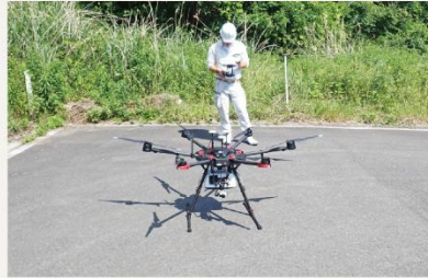
UAV（グリーンレーザー）
