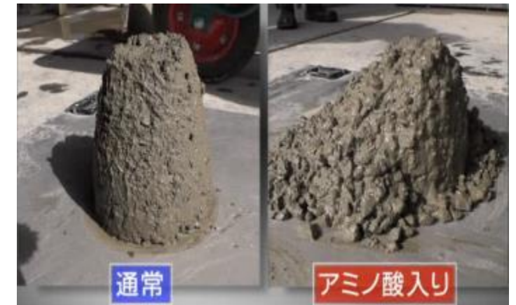
アミノ酸の有無によるスランプ試験結果 （アミノ酸の種類や配合によっては硬化しない）
