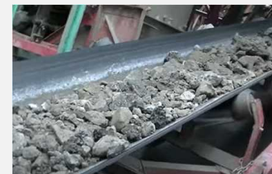
コンクリートの解体で 発生する多量の再生骨材
