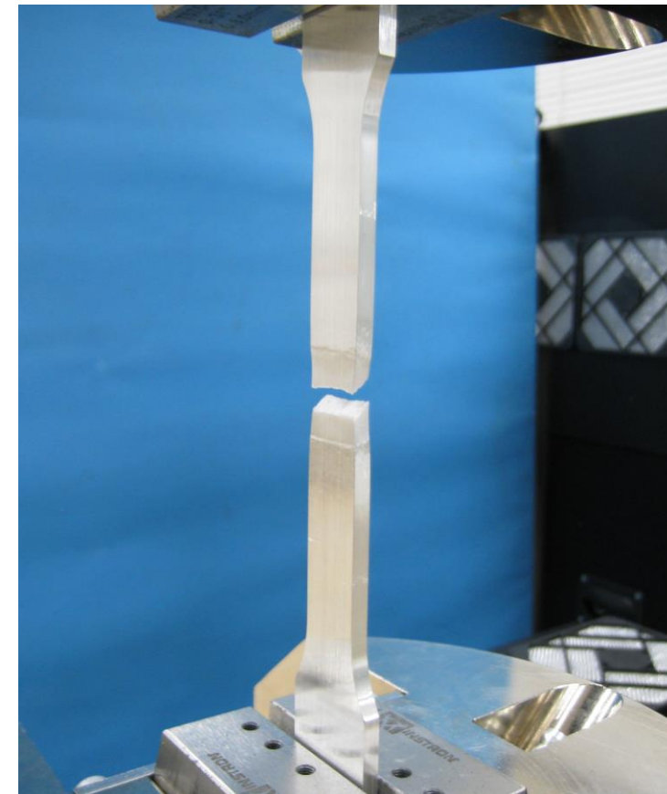
金属材料 引張試験状況
