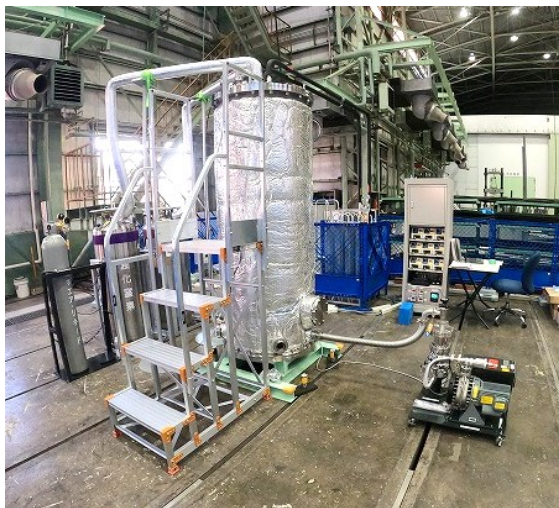
断熱システム熱特性評価用 試験装置（カロリメータ）外観
