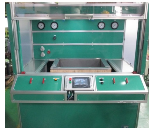
バルブ評価試験装置 (液化窒素)
