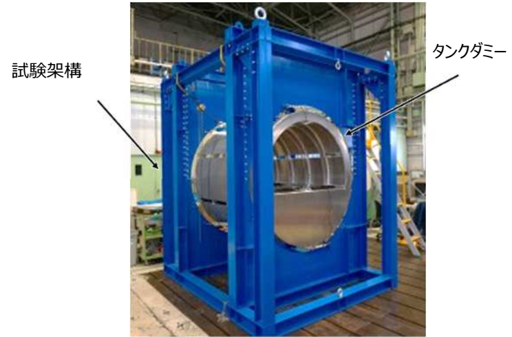
支持構造 振動試験 試験架構およびタンクダミー 外観
