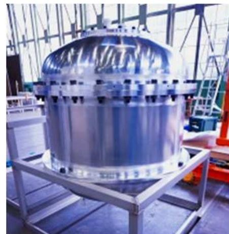
2023年度 金属模擬タンク一次試作 外観 (サイズΦ1.2m x 1.5m)
