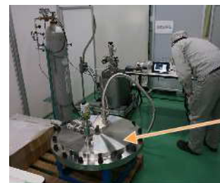
2023年度 点検孔シール気密性 評価試験試験治具
