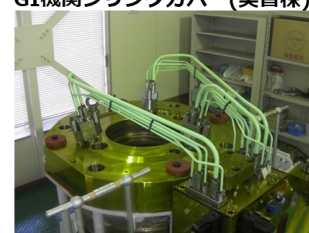
GI機関シリンダカバー(実習棟)
