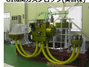
GI機関ガスブロック(実習棟)
