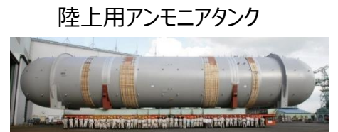
写真：2,000m 3 _W8m×H10m×L46.5m_340ton
