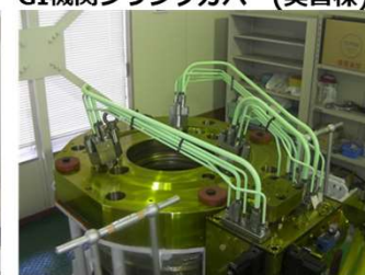
GI機関シリンダカバー(実習棟)
