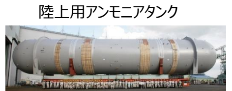
写真：2,000m 3 _W8m×H10m×L46.5m_340ton
