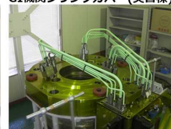
GI機関シリンダカバー(実習棟)
