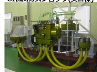
GI機関ガスブロック(実習棟)
