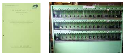
疲労DS マルチ回転曲げ疲労試験機 (3年間疲労試験)
