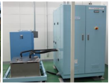
10kW中規模 スタック評価設備
