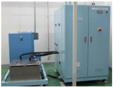
10kW中規模 スタック評価設備
