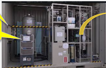
高圧水電解装置 (50kW級)
