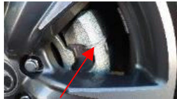
ブレーキパッド部に熱電対を埋め込み
