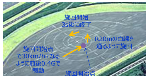
制動中旋回(旋回開始直後の過渡データ取得)
