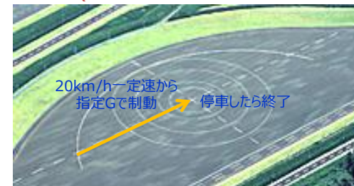
直進制動(各種スリップ率条件でのデータ取得)
