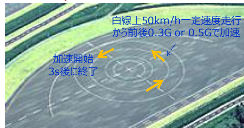
制動中旋回(旋回開始直後の過渡データ取得)
