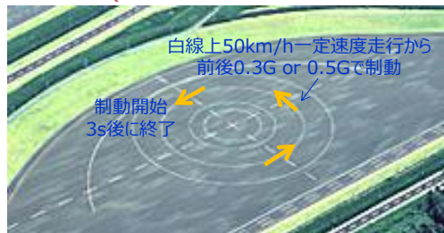
旋回急制動(制動開始直後の過渡データ取得)
