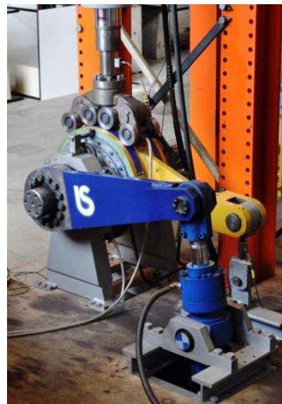
大型試験機での耐久試験の様子
