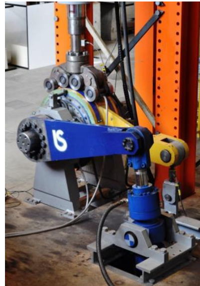
大型試験機での耐久試験の様子
