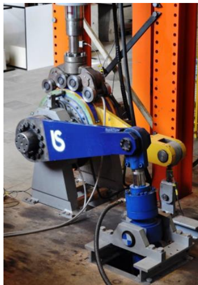
大型試験機での耐久試験の様子
