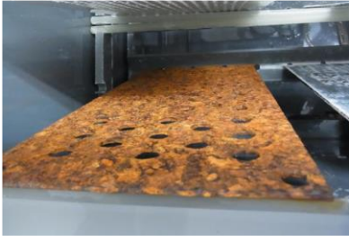
【写真：塩水噴霧による耐食試験例】
