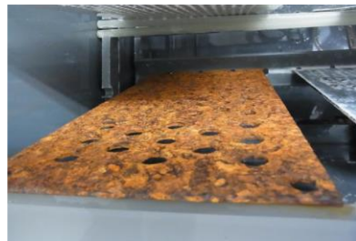
図：塩水噴霧による耐蝕試験姿
