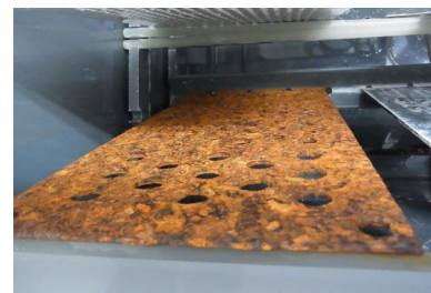
【写真：塩水噴霧による耐食試験例】
