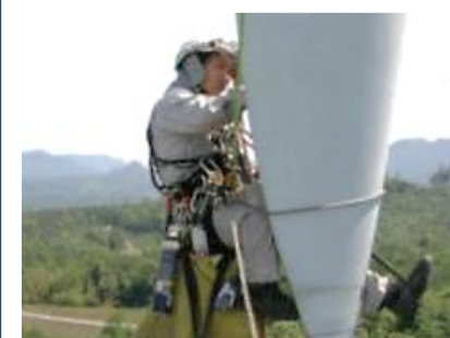
従前の導通試験状況
