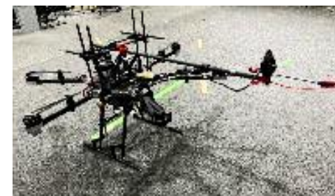
導通試験用ドローン
