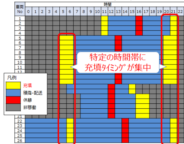
配送車両の充填時間のパターン（東京都江東区の水素STでの例）
