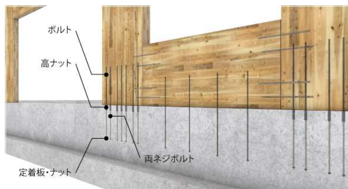
図 67 柱脚の接合例 (サミット CLT 工法)
